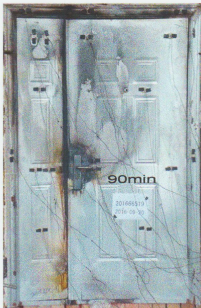
照片 2 耐火试验结束时试件情况
