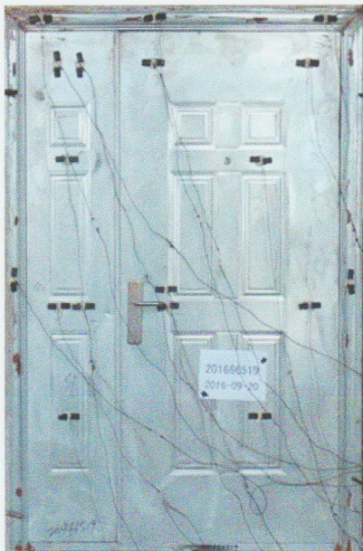
照片 1 耐火试验前试件情况
