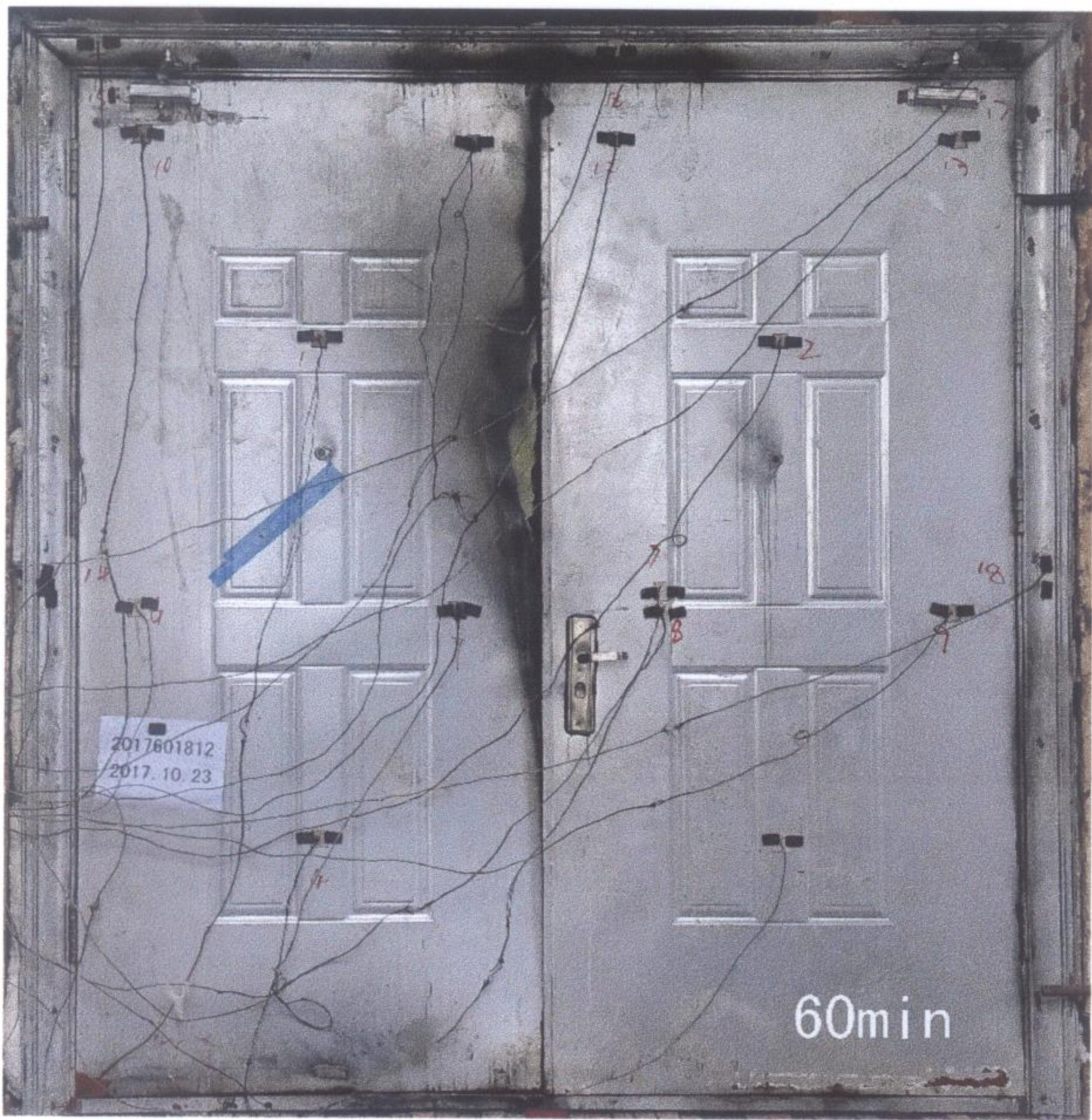
照片 2 耐火试验结束时试件情况
