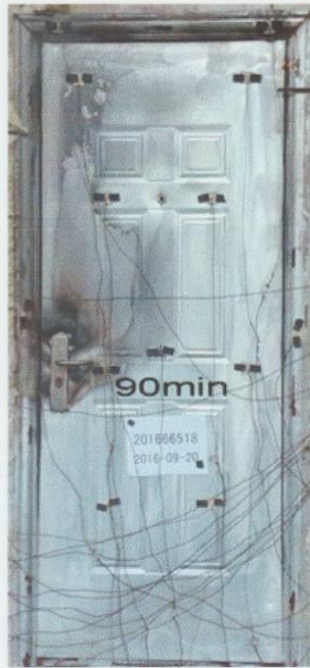
照片 2 耐火试验结束时试件情况
