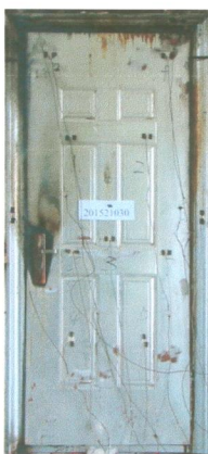
照片 2 耐火试验结束时试件情况
