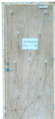
照片 2 耐火试验结束时试件情况
