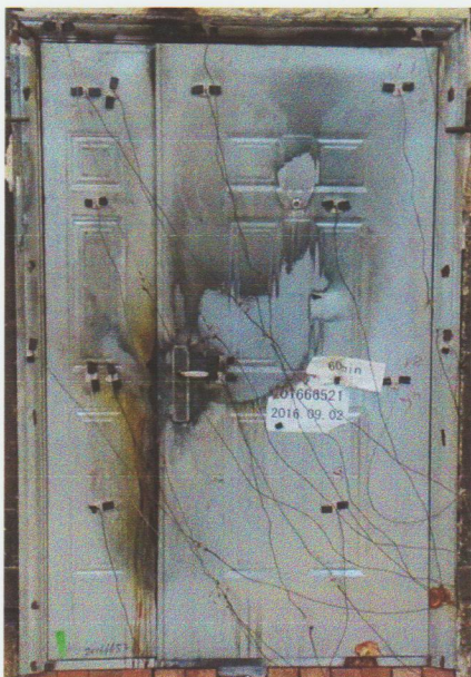
照片 2 耐火试验结束时试件情况
