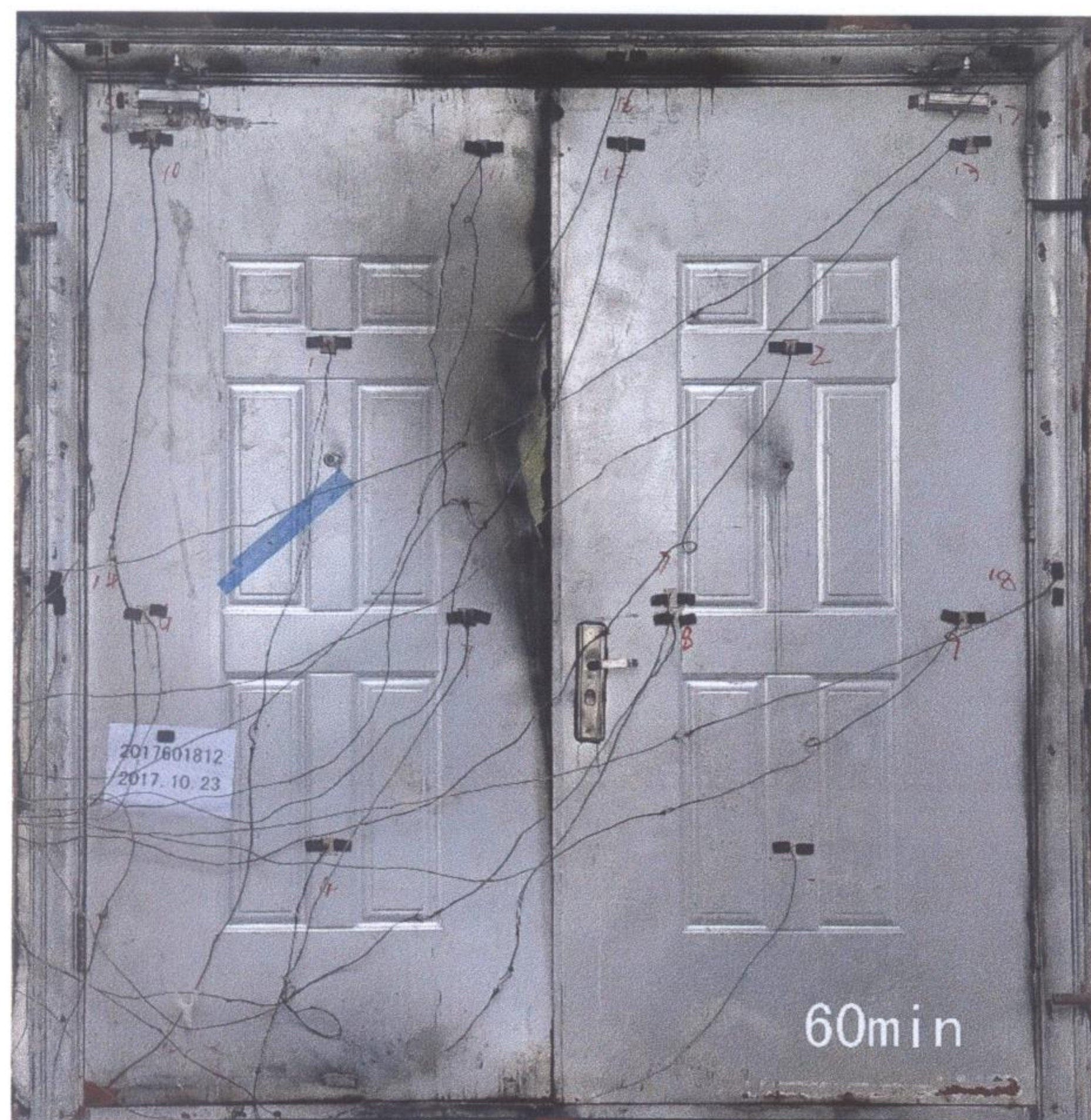
照片 2 耐火试验结束时试件情况
