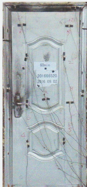
照片 2 耐火试验结束时试件情况
