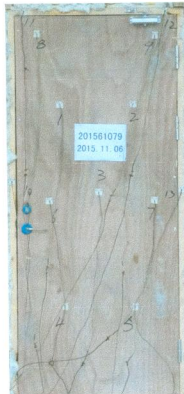
照片 2 耐火试验结束时试件情况
