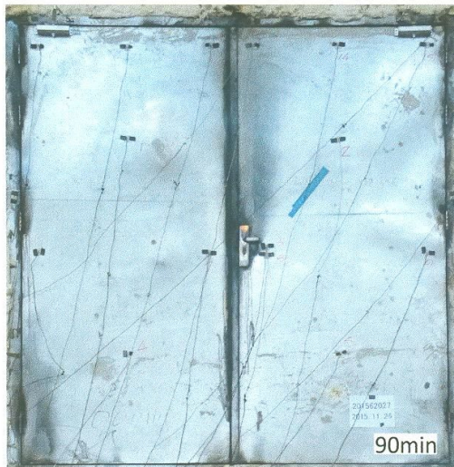
照片 2 耐火试验结束时试件情况
