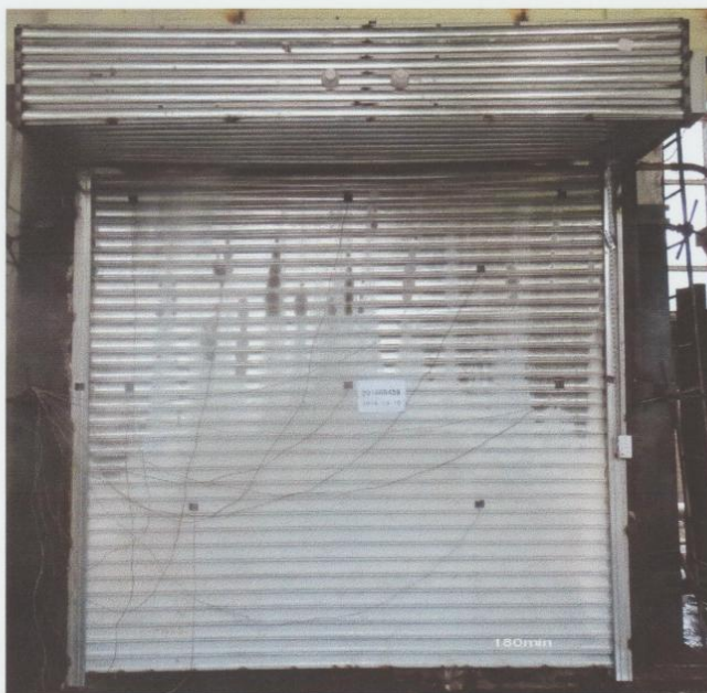
照片 2 耐火试验结束时试件情况
