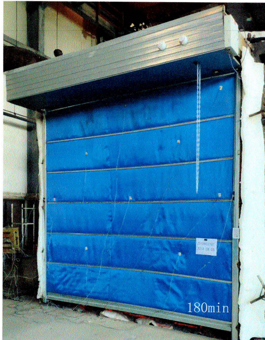
照片 2 耐火试验结束时试件情况
