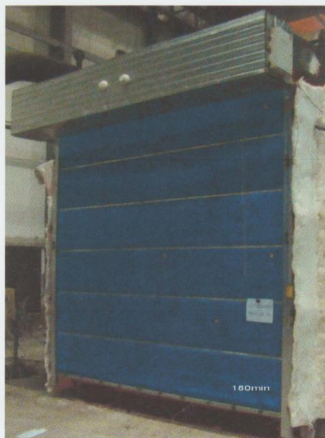
照片 2 耐火试验结束时试件情况
